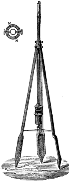
Fig. 278. — Baromètre de Fortin et son pied. — MM, suspension à la Cardan du baromètre de Fortin.
